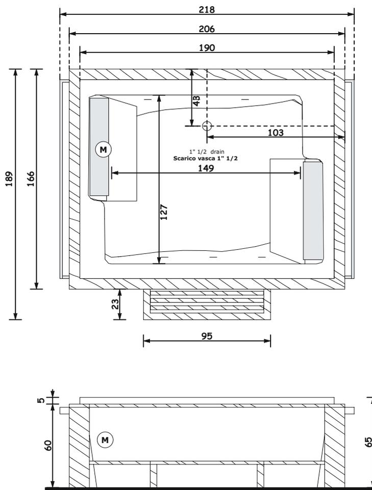
Motore Idromassaggio (M) Whirlpool Motor
